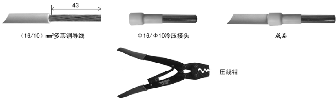
图7 电源线的线头制作
